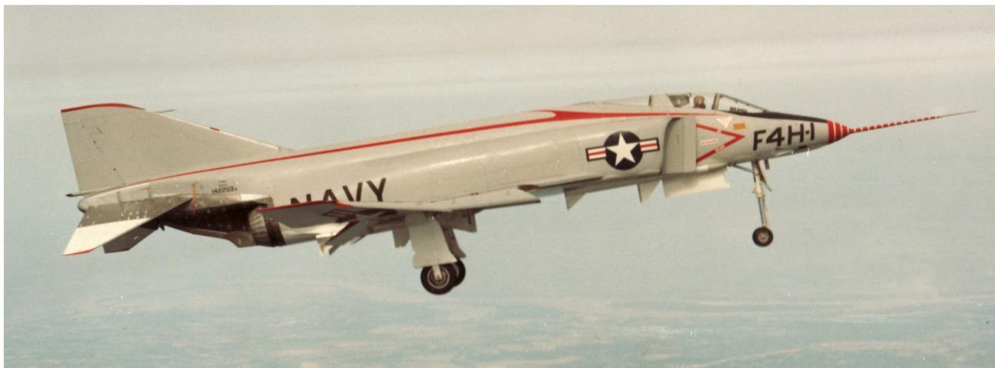
Las alas también tenían el característico *diente de sierra* para mejorar el control con el elevado ángulo de ataque. Los estabilizadores de cola estaban colocados en 23° en diedro invertido para mejorar el control en ángulos de ataque elevados y dejar limpia la salida de los motores.
