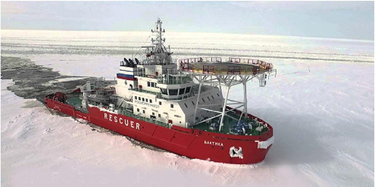
Desarrollado por AkerArctic, el rompehielos de rescate “Baltika” es el primer barco construido con un casco asimétrico que permite la ruptura de hielo no solamente navegando hacia adelante y atrás, sino también hacia los costados. De esta forma, el relativamente pequeño rompehielos “oblicuo” es capaz de abrir canales anchos en el hielo.
