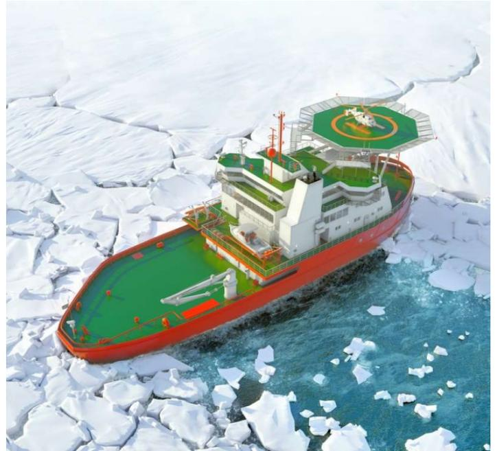
El buque tiene 76,4m de eslora y 20,5m de manga. Está propulsado por una planta diesel-eléctrica conformada por tres sistemas de generadores Wärtsilä 9L26 con una potencia combinada de 9 MW. Posee tres propulsores acimutales Steerprop de 2,5 MW, dos a popa y uno en proa.
