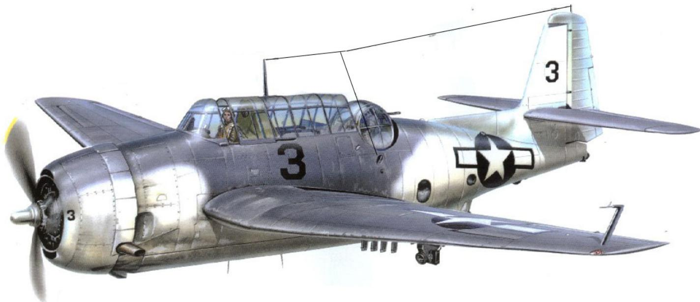
**TBM-3 con el camuflaje antisubmarino utilizado en el océano Atlántico con tonos de Dark Gull Grey y blanco insignia. Estas aeronaves se utilizaron para el ataque a los uboats alemanes. Se pueden observar lanzadores de cohetes y una cámara bajo el ala.**
